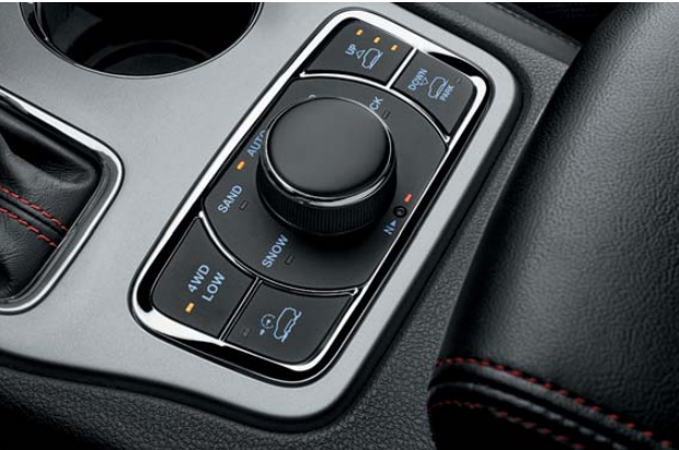
SELEC-TERRAIN®-SYSTEM MIT BERGAUF- UND BERGABFAHRHILFE
