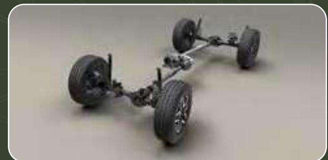
Mientras que el sistema Command-Trac® Part Time 4x4 proporciona torque a las cuatro ruedas para una tracción increíble. Su relación de rango bajo de 2.72:1 te permite trepar rocas y decir sí a todo tipo de aventuras.
