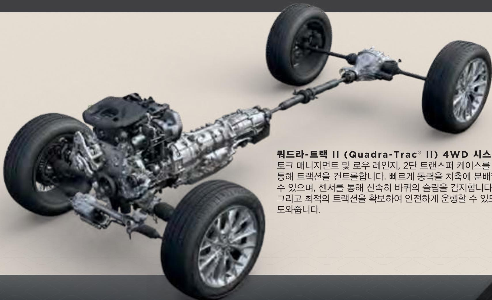
**쿼드라-트랙 II (Quadra-Trac® II) 4WD 시스템**은 토크 매니지먼트 및 로우 레인지, 2단 트랜스퍼 케이스를 통해 트랙션을 컨트롤합니다. 빠르게 동력을 차축에 분배할 수 있으며, 센서를 통해 신속히 바퀴의 슬립을 감지합니다. 그리고 최적의 트랙션을 확보하여 안전하게 운행할 수 있도록 도와줍니다.
