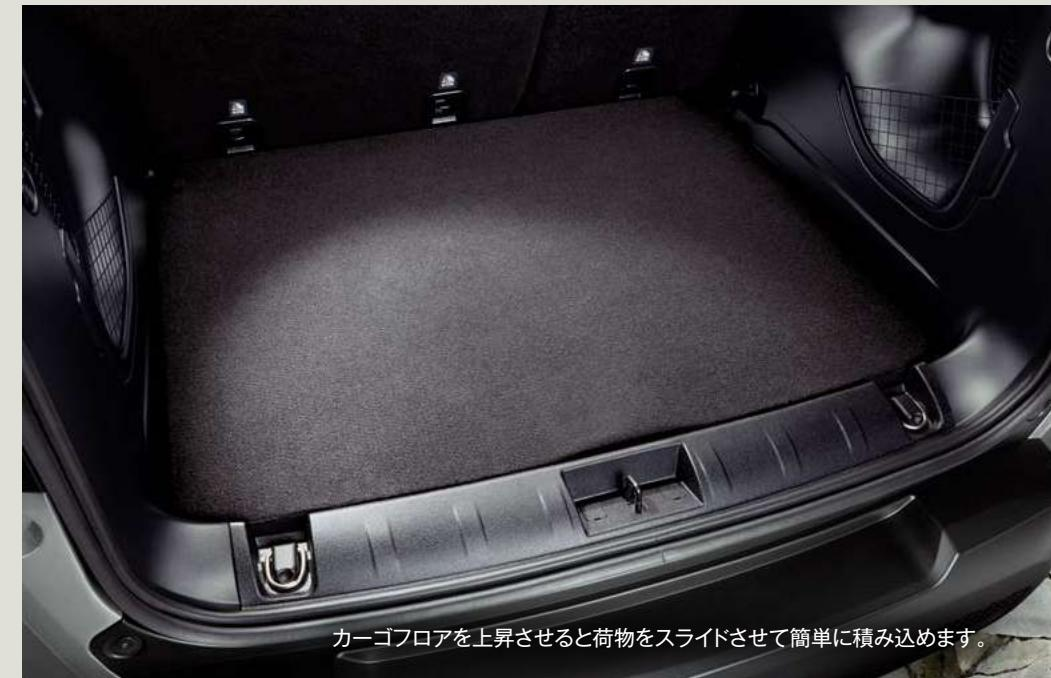
カーゴフロアを上昇させると荷物をスライドさせて簡単に積み込めます。
