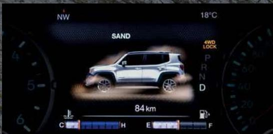
**SAND/MUD(砂/泥)** 電動4x4システムにより低速時のトルクとトラクションを向上。シャーシコントロール、ディファレンシャル、変速比を駆使することで砂地やぬかるみでの力強い走行を可能にします。
