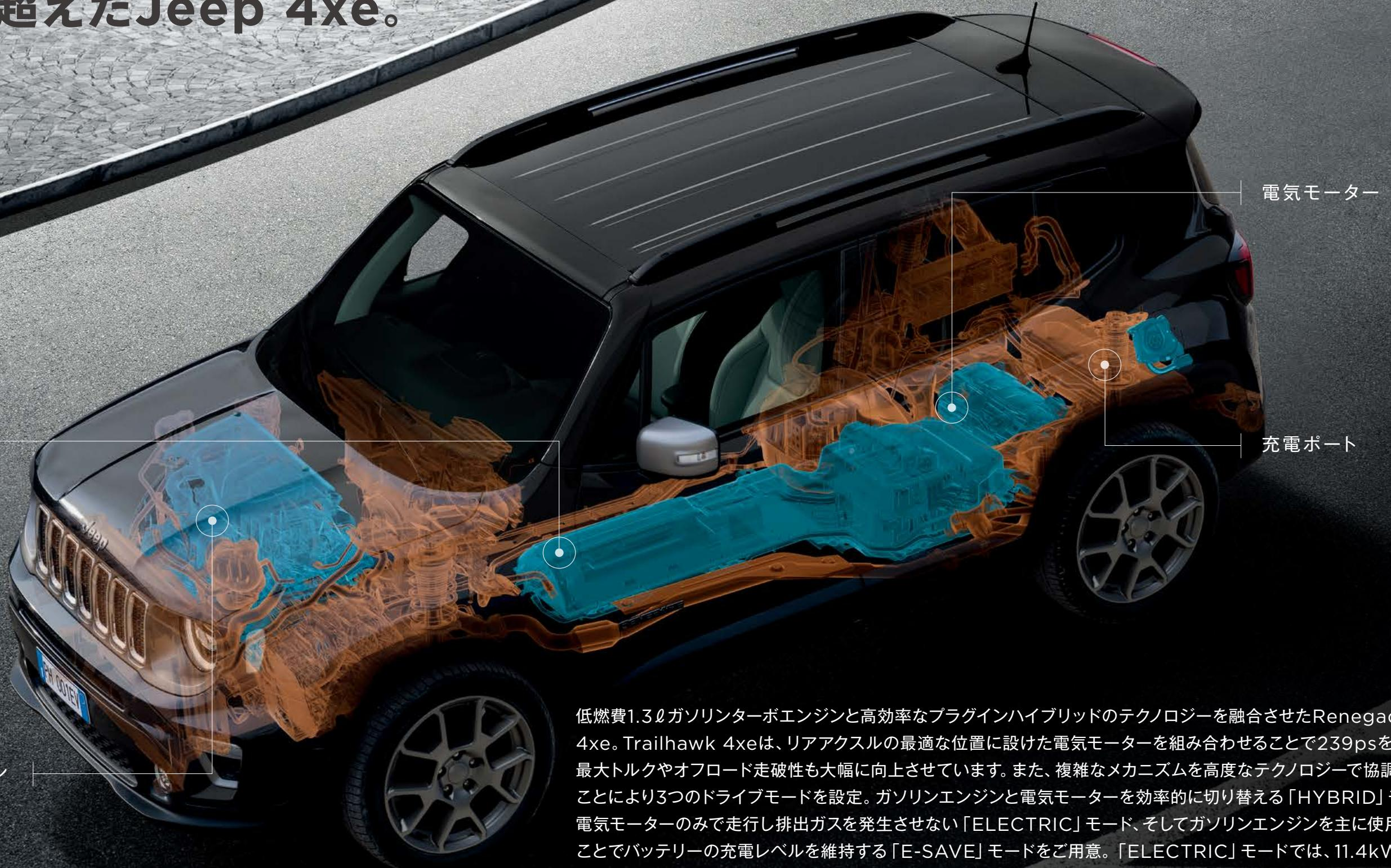
低燃費1.3ℓガソリンターボエンジンと高効率なプラグインハイブリッドのテクノロジーを融合させたRenegade 4xe。Trailhawk 4xeは、リアアクスルの最適な位置に設けた電気モーターを組み合わせることで239psを発揮。最大トルクやオフロード走破性も大幅に向上させています。また、複雑なメカニズムを高度なテクノロジーで協調させることにより3つのドライブモードを設定。ガソリンエンジンと電気モーターを効率的に切り替える「HYBRID」モード、電気モーターのみで走行し排出ガスを発生させない「ELECTRIC」モード、そしてガソリンエンジンを主に使用することでバッテリーの充電レベルを維持する「E-SAVE」モードをご用意。「ELECTRIC」モードでは、11.4kWhバッテリーと環境にやさしい電気モーターのポテンシャルを最大限に引き出すことで、まったく排気ガスを出さずに、最大で走行距離52kmを実現。高速域でも十分パワフルな加速を味わえます。強さも優しさも手に入れた一台が、次世代のアーバンシーンを軽やかに駆け抜けます。
