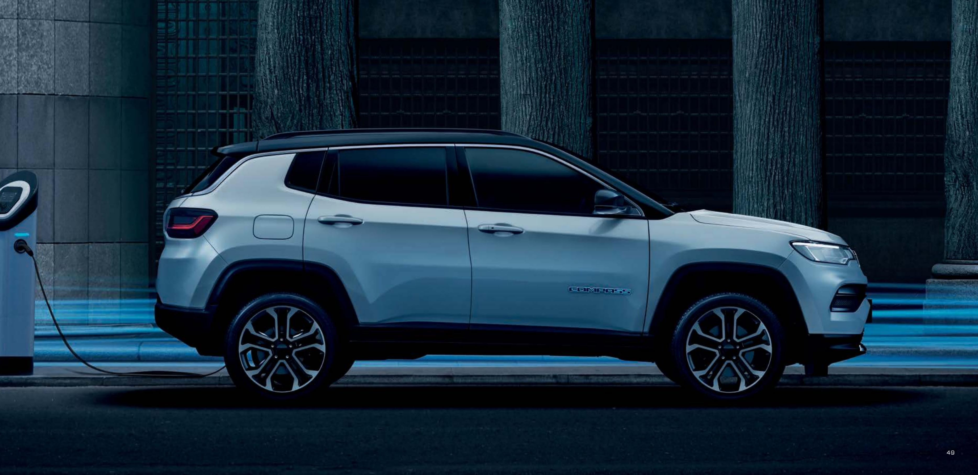
Unterwegs können Sie den Jeep® Compass 4xe an öffentlichen Ladestationen mit bis zu 7,4 Kilowatt in durchschnittlich 100 Minuten aufladen.
