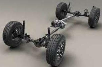
Mientras que el sistema Command-Trac® Part Time 4x4 proporciona torque a las cuatro ruedas para una tracción increíble. Su relación de rango bajo de 2.72:1 te permite trepar rocas y decir sí a todo tipo de aventuras.
