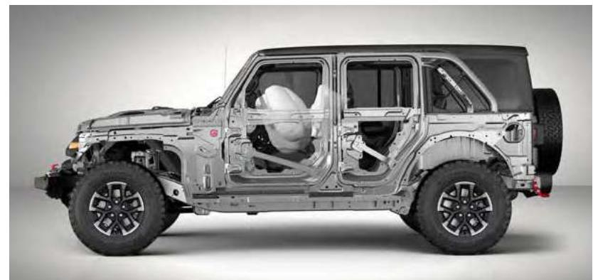
Un marco de seguridad de acero de alta resistencia crea un chasis rígido y una base sólida para ayudar a maximizar la protección en caso de colisión.
