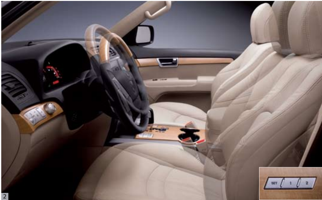
2. 운전자세 메모리 시스템* 운전석 시트, 스티어링 휠, 아웃사이드 미러의 위치를 기억하여 원터치로 재현해줌으로써 운전자의 편의성을 향상시켰습니다.
