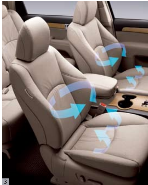
3. 운전석/동승석 통풍시트* 시트내 통풍팬을 이용해 바람을 발생시켜 쾌적한 운전이 가능하도록 도와 드립니다.
