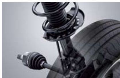
전폭감응형 댐퍼 * 서스펜션 댐퍼의 감쇠력을 조절하여 보다 나은 승차감을 구현하고 조종안정성을 높여드립니다.
