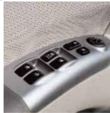
◀ **POWER CONTROLS.** POWER WINDOWS, MIRRORS AND DOOR LOCKS ARE STANDARD. AND THE POWER WINDOWS EVEN INCLUDE A ONE-TOUCH DRIVER'S EXPRESS-DOWN FEATURE FOR ADDED CONVENIENCE.
