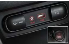
AUX & USB 단자 급속 충전 USB 단자 (Quick Charge 2.0 지원)
