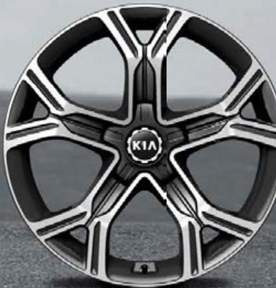
19-Zoll-Leichtmetallfelgen mit Bereifung 225/40 R19 (vorn) und 255/35 R19 (hinten) (Serie im GT)
