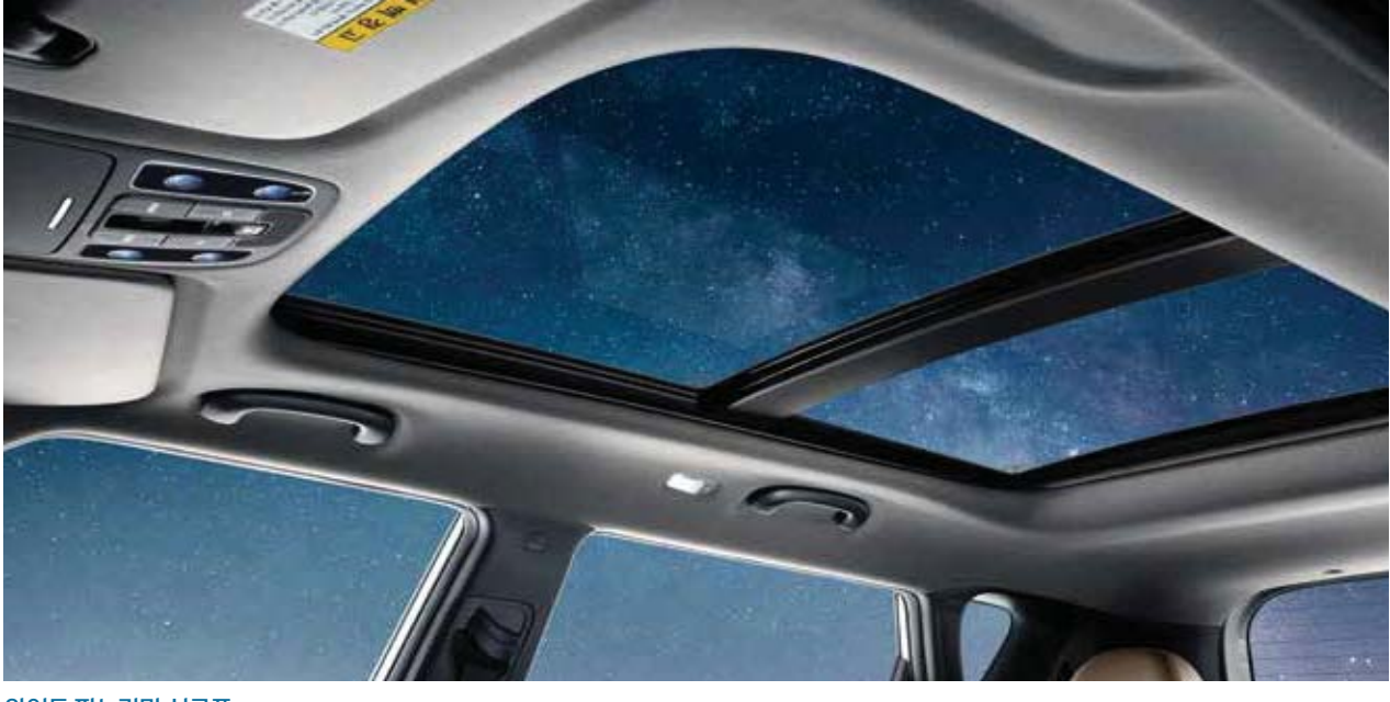
와이드 파노라마 선루프 루프 전면을 덮는 전동 1피스 대형 롤바인드 방식으로 탁월한 개방감과 채광 편의성을 제공합니다.
