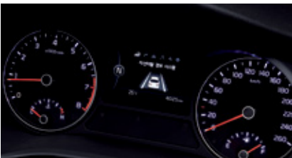
슈퍼비전 클러스터 (4.3인치 컬러 TFT LCD)
