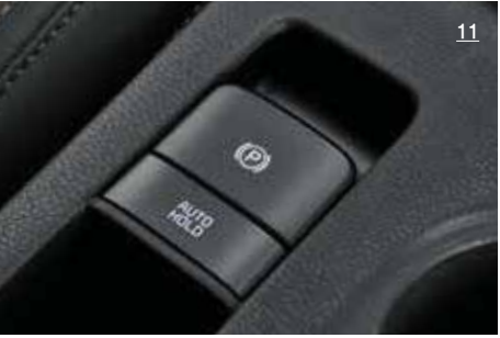
07 풀오토 에어컨 / 08 버튼시동 스마트키 시스템 / 09 슬라이딩 콘솔* / 10 매뉴얼 에어컨 / 11 전자식 파킹 브레이크 / 12 1열 통풍시트 & 1, 2열 히터드 시트*
