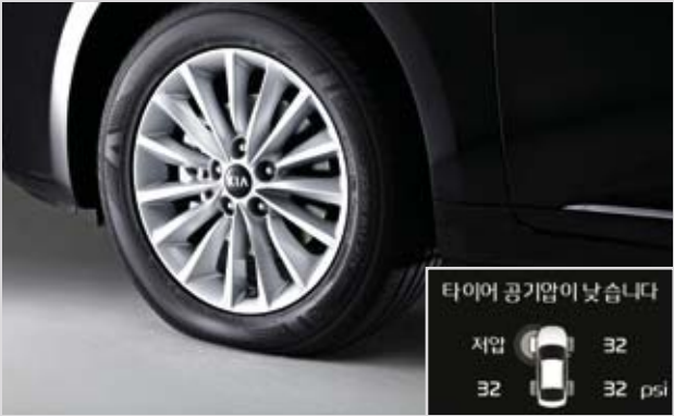
개별 타이어 공기압 경보 시스템 (TPMS) 타이어의 압력을 센서로 감지하여 압력이 낮을 때 운전자에게 공기압이 낮은 타이어의 위치를 알려줍니다.
