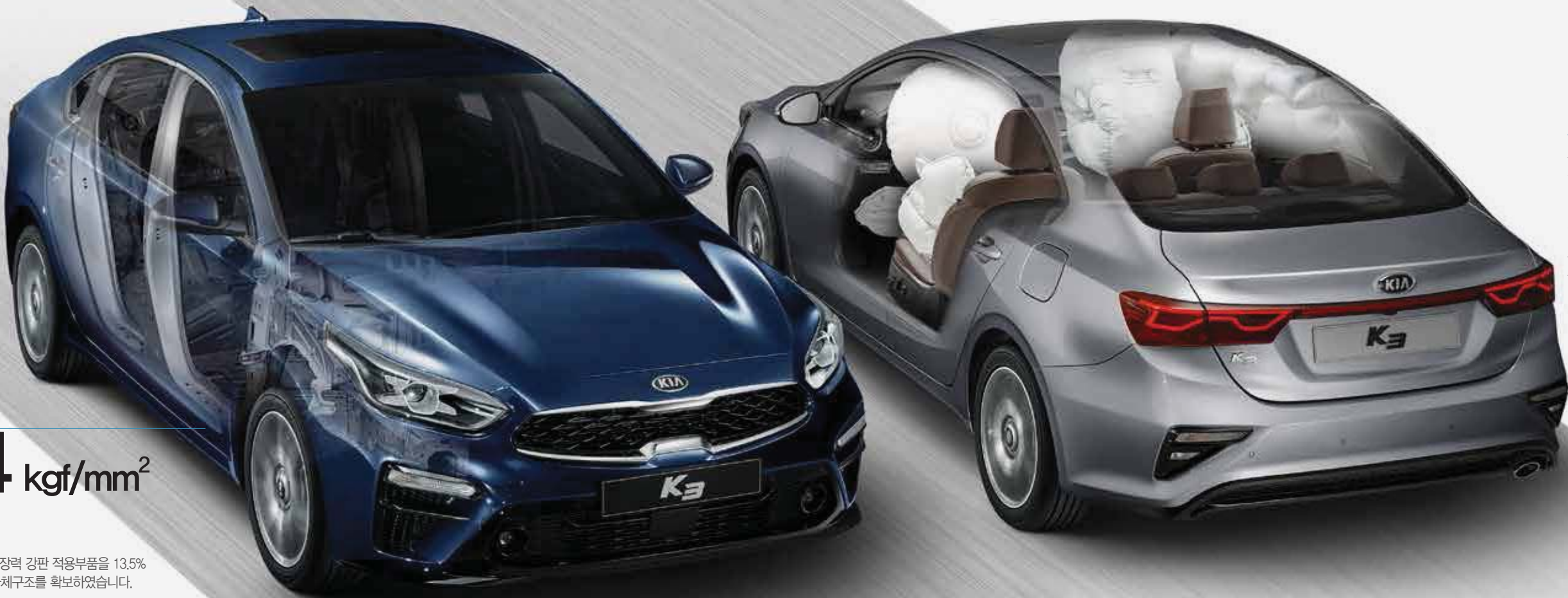
운전석/동승석 어드밴스드 에어백 * 충돌정도에 따라 에어백의 팽창 압력을 저압 팽창과 고압 팽창으로 구분하여 에어백의 전개를 제어하는 어드밴스드 에어백을 적용하여 탑승자를 보호합니다.
