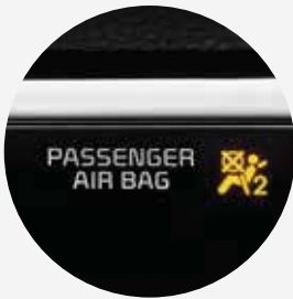
운전석/동승석 어드밴스드 에어백 * 충돌정도에 따라 에어백의 팽창 압력을 저압 팽창과 고압 팽창으로 구분하여 에어백의 전개를 제어하는 어드밴스드 에어백을 적용하여 탑승자를 보호합니다.
