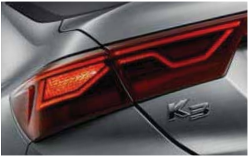
급제동 경보 시스템 (ESS) 차량 급제동 시 제동등과 비상등을 점멸시켜 후방차량에 위급상황을 경고해 주는 안전 보조장치입니다.
