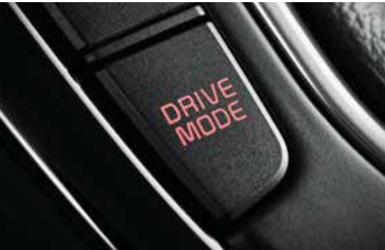
주행모드 통합제어 시스템 주행 특성에 따라 COMFORT-ECO-SMART 모드로 선택할 수 있어 주행 환경이나 운전자 취향에 맞는 최적의 드라이빙을 즐기실 수 있습니다. ※ 변속기를 'S'단으로 이동시 SPORT 모드 선택 가능
