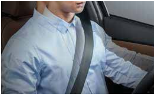
시트 안전벨트 프리텐셔너 (앞좌석 어댑티브 로드리미터 적용) * 센서가 충격을 감지하면 안전벨트를 되감아 승객을 시트에 밀착시킴으로써 몸이 앞으로 쏠리는 것을 방지하며, 충돌 직후 가해지는 안전벨트의 압박 상태를 느슨하게 하여 안전벨트에 의한 2차 상해를 경감시켜 줍니다.
