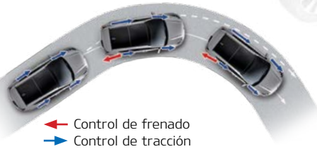
Control de Tracción Avanzado en Curvas (ATCC) El Control de Tracción Avanzado en Curvas monitorea y analiza las condiciones de la carretera, asegurando que la fuerza adecuada esté concentrada en las llantas con el máximo agarre, impidiendo así algún derrape o pérdida de control.
