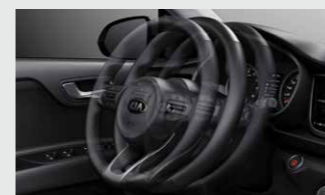
Höhen- und tiefenverstellbares Lenkrad Durch das mehrfach verstellbare Lenkrad und den höhenverstellbaren Fahrersitz findet jeder seine perfekte Sitzposition.
