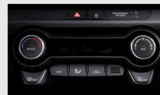
Klimaautomatik* Unabhängig von äußeren Einflüssen hält dieses System die eingestellte Temperatur automatisch konstant.
