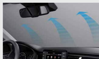
Antibeslagsystem* Wenn die Frontscheibe beschlägt, startet das sensorgesteuerte System automatisch das Gebläse.
