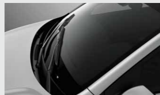
Die aerodynamischen Wischer liegen bei hohen Geschwindigkeiten besser an der Frontscheibe an.
