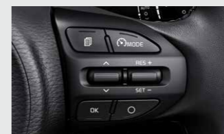
Geschwindigkeitsregelanlage** Das mit einem Geschwindigkeitsbegrenzer kombinierte System hält das Tempo konstant und lässt sich bequem über die Lenkradtasten bedienen.
