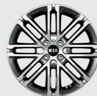
17-Zoll-Leichtmetallfelgen mit Bereifung 205/45 R17 (Serie für Platinum Edition, optional für Spirit)
