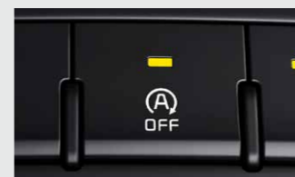
Start-Stopp-System ISG Das bei Schaltgetriebe serienmäßige System schaltet den Motor automatisch ab, wenn das Fahrzeug zum Stehen kommt.
