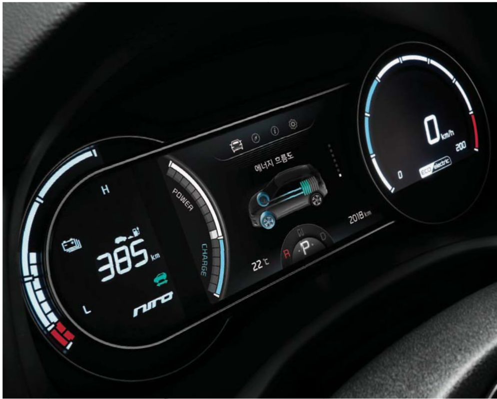
슈퍼비전 클러스터 (7인치 칼라 TFT LCD) 노말, 스포츠, 에코 등의 운전 모드에 따라 정보를 구성하는 디자인과 컬러가 변화되어 차별화된 드라이빙 감성을 제공합니다.
