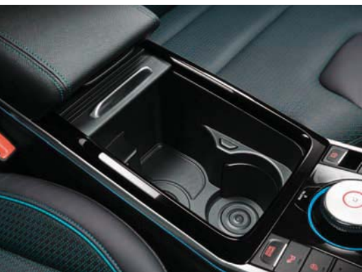
센터 콘솔 / 다용도 콘솔 트레이 슬라이딩 커버 내부에 컵홀더, 휴대폰 충전코드 인출홀 적용으로 IT기기 활용성 및 수납 편의성을 높였습니다.
