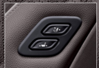
동승석 워크인 디바이스 운전자가 손쉽게 동승석의 위치와 각도를 조절하여 뒷좌석 및 동승석 탑승자에게 편의성을 제공합니다.
