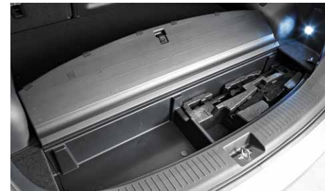
Staufach für Gepäckraumabdeckung Bei Nichtgebrauch kann die Gepäckraumabdeckung in diesem praktischen Fach verstaut werden.
