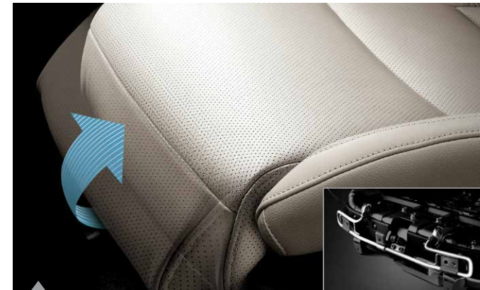
Elektrisch verlängerbare Beinauflage** Groß gewachsene Fahrer werden dieses Element des Fahrersitzes besonders zu schätzen wissen.
