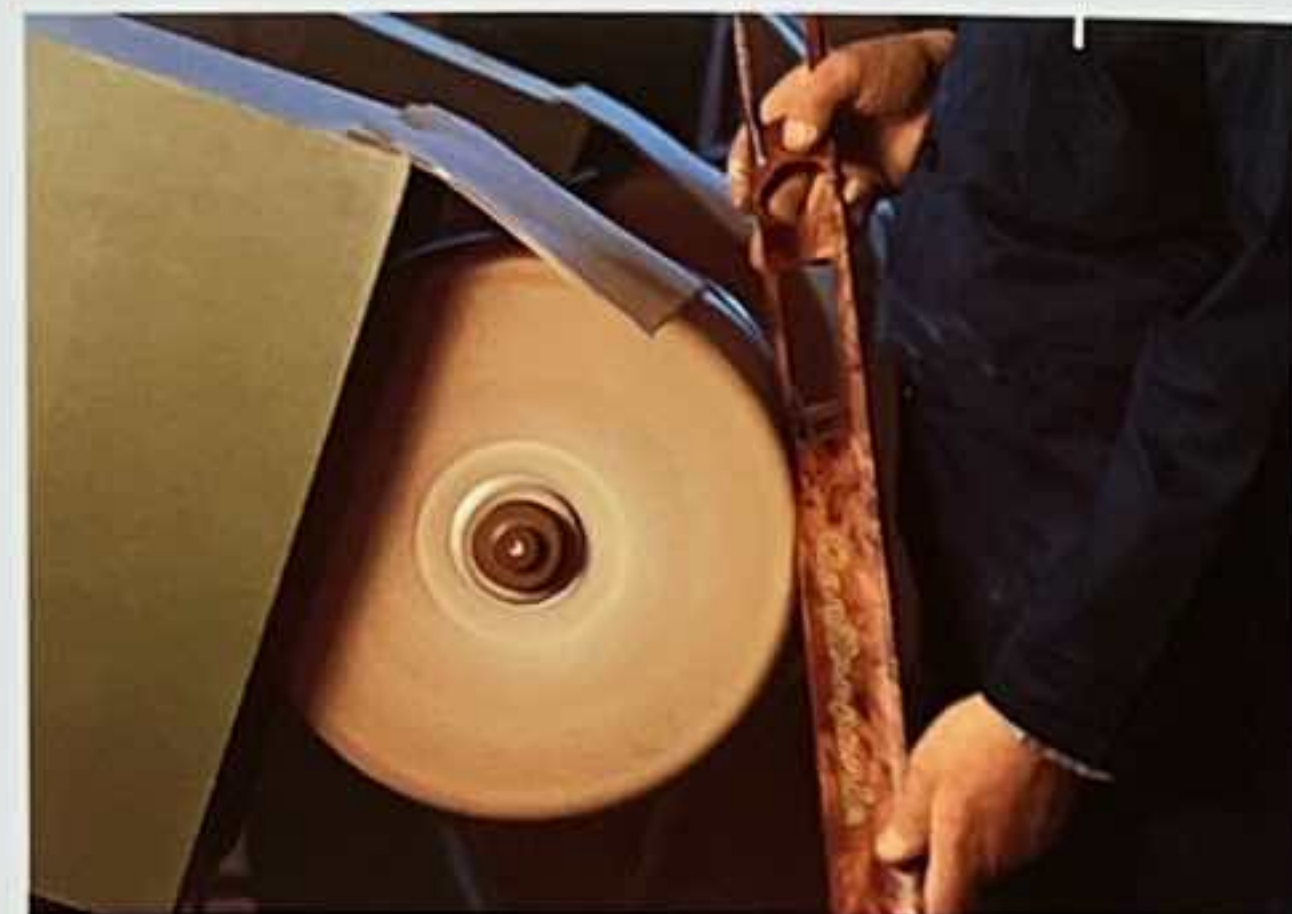
Das Wurzelholz des Armaturenbretts ist handpoliert.
