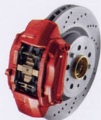
Festsattelbremsen an den Vorderrädern und innenbelüftete, gelochte Bremsscheiben 330 X 32 mm (Sport GT)
