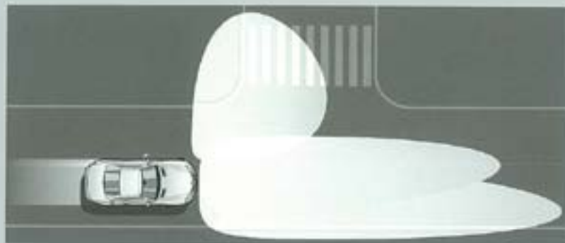
Afslagverlichting Na een bepaalde stuur- inslag of nadat u het knipper- licht hebt ingeschakeld, wordt automatisch de mist- lamp aan de binnenzijde van de bocht ingeschakeld (bij snelheden onder 40 km/h).
