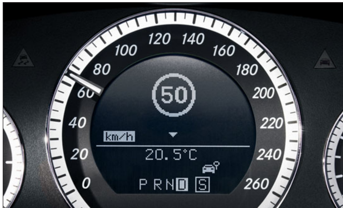
Lo Speed Limit Assist segnala al guidatore anche i limiti di velocità temporanei.
