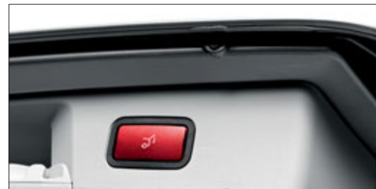
Con un semplice pulsante è possibile arrestare la corsa del portellone posteriore EASY-PACK lasciandolo anche in una posizione più bassa.
