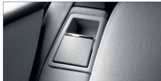
La maniglia di sbloccaggio sul montante centrale agevola notevolmente il ribaltamento degli schienali posteriori.
