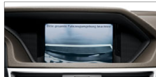
L'obiettivo grandangolare della telecamera per la retromarcia assistita è in grado di riprendere l'area retrostante la vettura.
