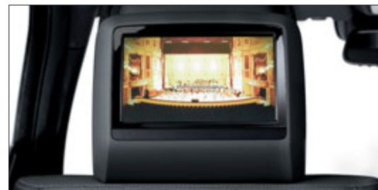
I due display per il Rear Seat Entertainment System sono integrati nei poggiatesta dei sedili anteriori.
