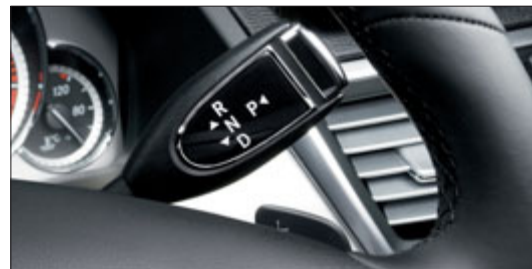
Sulle versioni V6 e V8 il cambio si aziona premendo un tasto sulla leva DIRECT SELECT al volante.
