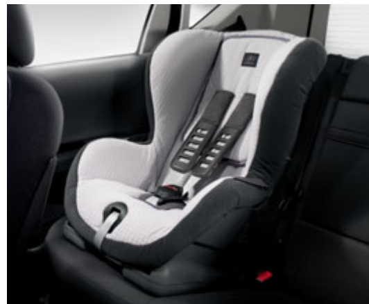
Il sistema di fissaggio dei seggiolini per bambini ISOFIX sui sedili posteriori con TopTether garantisce un solido ancoraggio del seggiolino, a vantaggio di una maggiore protezione.
