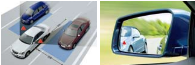
左右斜め後ろを走るクルマの存在を知らせる「▲」のインジケーター
