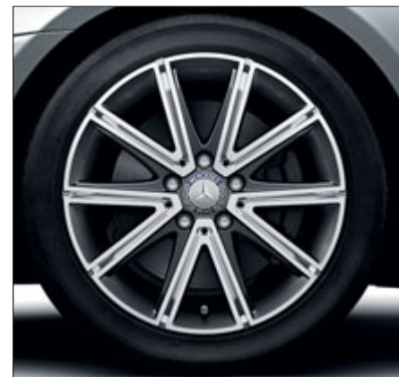
Jantes alliage à 10 branches, argent palladium, finition brillante, pneus 225/45 R 17 (AV) et 245/40 R 17 (AR) (option, code R93).
