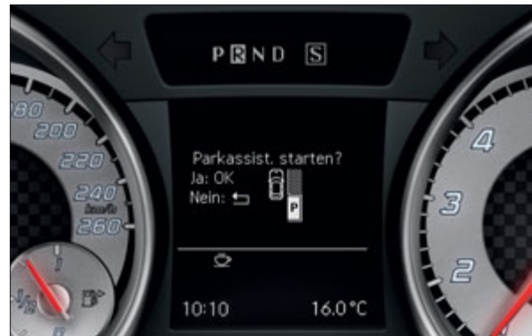
Le stationnement guidé signale les places de parking adéquates au conducteur et lui fournit des indications pour l'aider à se garer.
