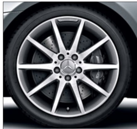
Llanta de aleación AMG multirradio, color gris titanio, pulida a alto brillo, con neumáticos 235/40 R 18 delante y 255/35 R 18 detrás (opcional, código 796).
