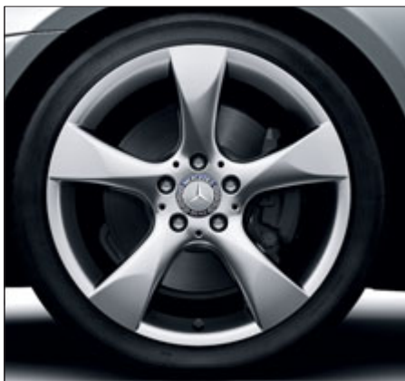
Llanta de aleación de 5 radios con neumáticos 225/40 R 18 delante y 245/35 R 18 detrás (opcional, código R32).
