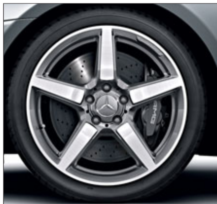
Llanta de aleación AMG de 5 radios, gris titanio, pulida a alto brillo, con neumáticos 235/40 R 18 delante y 255/35 R 18 detrás (de serie para SLK 55 AMG, código 790).
