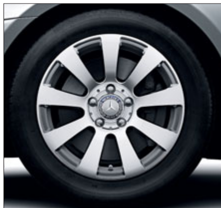
Llanta de aleación de 9 radios 1 con neumáticos 205/55 R 16 delante y 225/50 R 16 detrás (de serie para SLK 250 CDI BlueEFFICIENCY, código R49).
