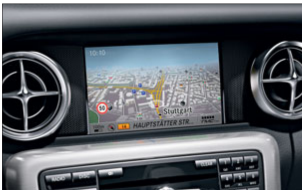
El indicador de velocidad límite informa al conductor en el cuadro de instrumentos y en el display central de COMAND Online.
