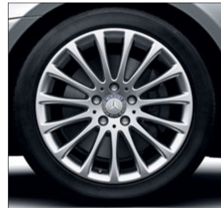
Llanta de aleación multirradio con neumáticos 225/45 R 17 delante y 245/40 R 17 detrás (opcional, código R81).
