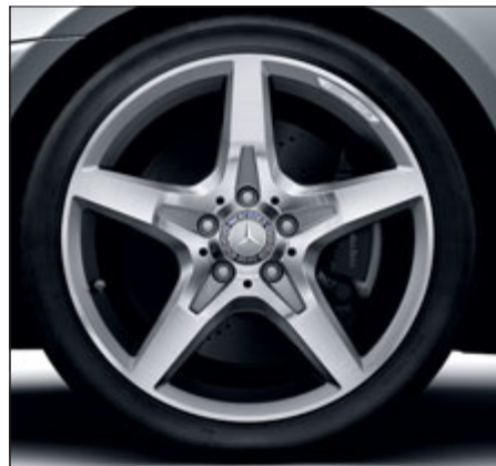
Llanta de aleación AMG de 5 radios pulida a alto brillo con neumáticos 225/40 R 18 delante y 245/35 R 18 detrás (paquete deportivo AMG, código 782).
