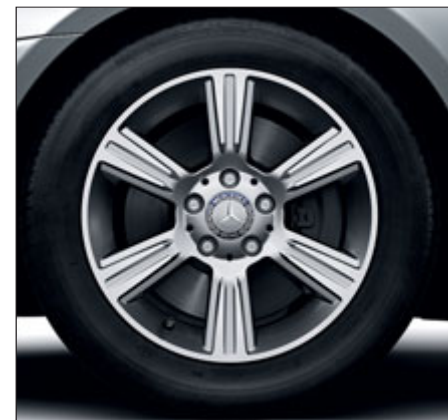
Llanta de aleación 2 de 6 radios color plata titanio, neumáticos 205/55 R 16 (accesorio genuino).
