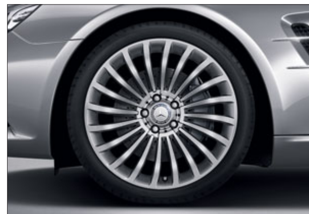
Jantes alliage multibranches avec monte mixte 255/35 R 19 à l'avant et 285/30 R 19 à l'arrière (option, code 11R).
