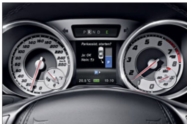
L'Aide au Parking Active signale les emplacements adéquats au conducteur et, si celui-ci le souhaite, gère la manœuvre de stationnement.
