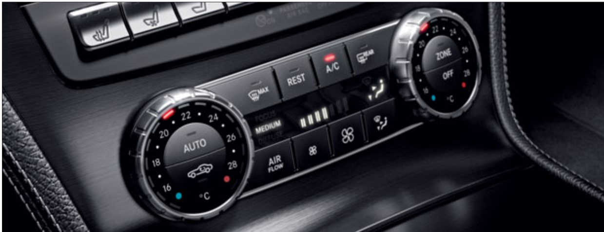
La climatización automática de confort THERMOTRONIC de serie vela por una temperatura agradable en el interior.
