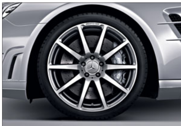
Llanta forjada AMG de 10 radios, color gris titanio y superficie pulida con neumáticos 255/35 R 19 delante y 285/30 R 20 detrás (opcional, sólo para modelos AMG, código 766).
