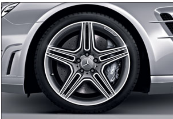
Llanta de aleación AMG de 5 radios dobles, color gris titanio y pulida a alto brillo, con neumáticos 255/35 R 19 delante y 285/30 R 19 detrás (de serie y sólo para el SL 63 AMG, código 793).
