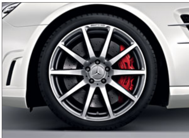
Llantas forjadas AMG de 10 radios (pinzas de freno en color rojo opcionales).
