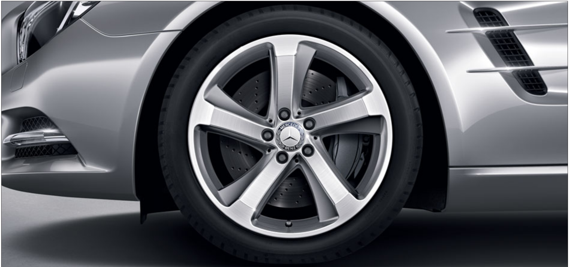
Llamativa llanta de aleación de 5 radios con neumáticos 225/40 R 18 delante y 285/35 R 18 detrás.
