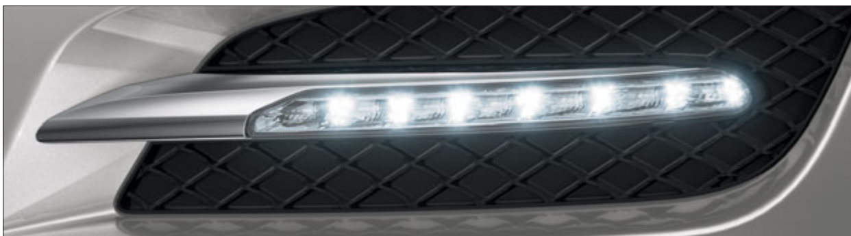
Las luces diurnas de diodos luminosos de serie mejoran la percepción del vehículo por los demás usuarios de la vía.
