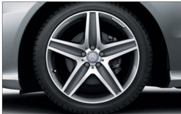
Llanta de aleación AMG de 5 radios con neumáticos 265/40 R 20 (opcional, código 758).
