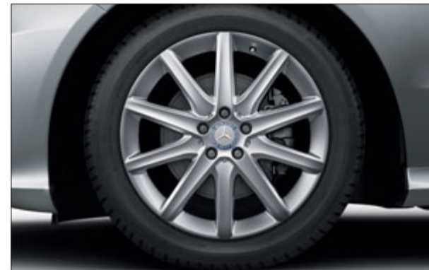
Llanta de aleación de 10 radios con neumáticos 255/50 R 19 (opcional, de serie para R 500 4MATIC, código R26).
