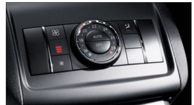
La unidad de mandos trasera permite ajustar con precisión la temperatura y el caudal de aire deseados.
