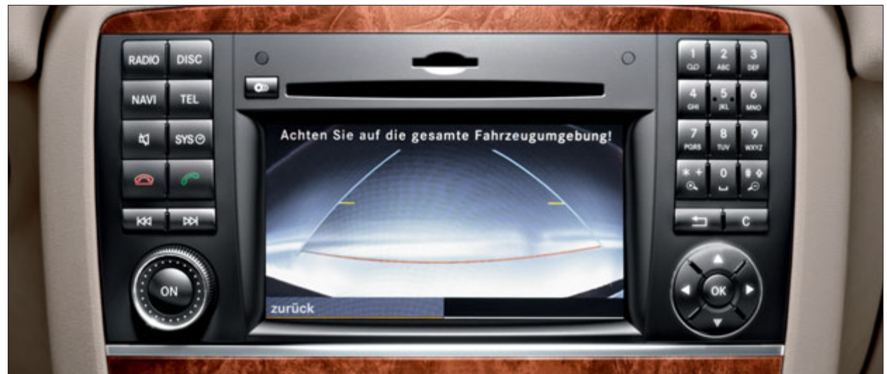
La cámara de marcha atrás muestra la zona detrás del vehículo.
