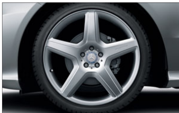
Llanta de aleación AMG de 5 radios con neumáticos 265/40 R 21 (opcional, código 777).
