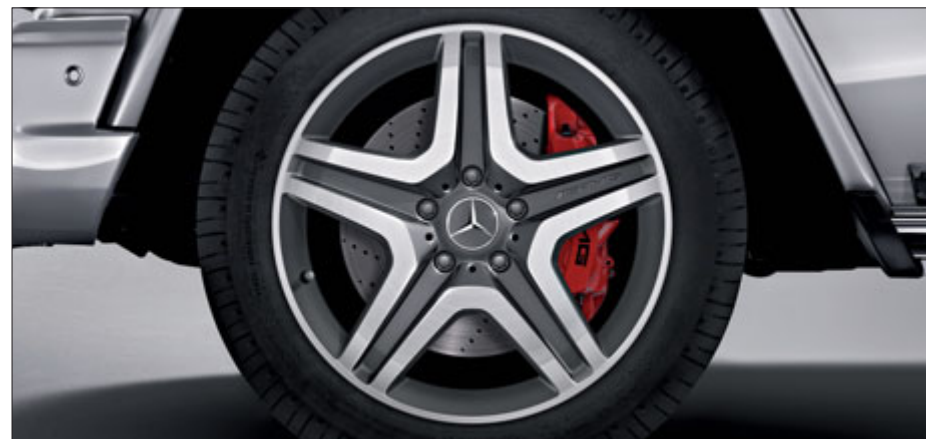
Jante alliage AMG à 5 branches avec pneus 275/50 R 20, peinte en gris titane, finition brillante (série sur G 65 AMG, code RM1).
