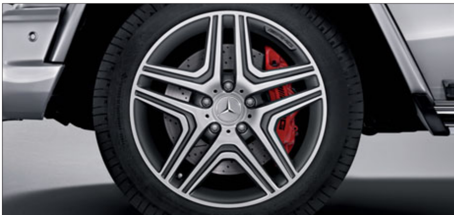
Jante alliage AMG à 5 doubles branches avec pneus 275/50 R 20, peinte en gris titane, finition brillante (série sur G 63 AMG, code R10).
