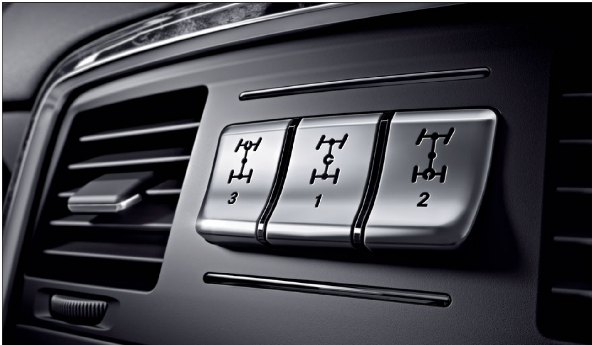
Les trois blocages de différentiel à 100 % contribuent de manière essentielle aux aptitudes tout-terrain de la Classe G.
