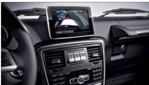
Le visuel central de COMAND Online* affiche la zone située à l'arrière du véhicule pendant la manœuvre de stationnement.
