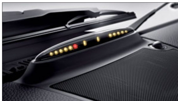
Les LED de l'aide au stationnement signalent la distance qui sépare le véhicule de l'obstacle.
