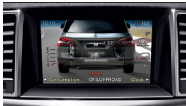
Le visuel COMAND affiche le programme de conduite sélectionné ainsi que le profil du terrain et le degré de déclivité.
