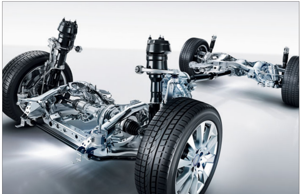
Le train de roulement de série avec système d'amortissement sélectif s'adapte rapidement et avec précision à toutes les conditions de marche.
