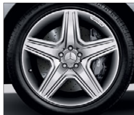
Jante alliage AMG à 5 branches en finition gris titane brillant, avec pneus 265/45 R 20 (de série sur ML 63 AMG, code 778).
