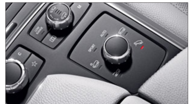
Un sélecteur rotatif placé sur la console centrale permet de choisir le programme de conduite le mieux adapté à la situation.
