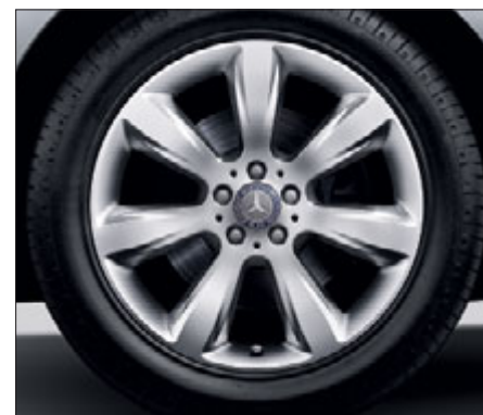
Jante alliage à 7 branches avec pneus 255/50 R 19 (en option sur tous les modèles sauf ligne Fascination et ML 63 AMG, code R53).
