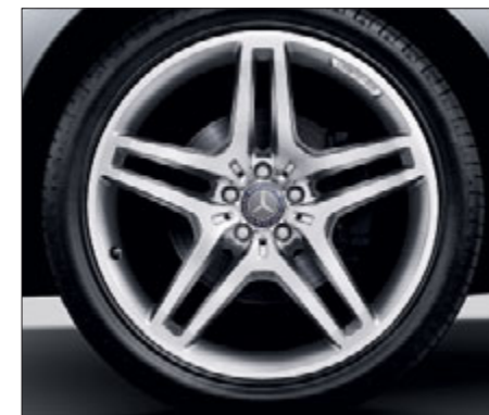
Jante alliage AMG à 5 doubles branches en finition brillante, avec pneus 265/40 R 21 (en option sur tous les modèles sauf ML 63 AMG, Code 757).
