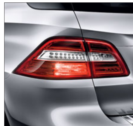
Feux arrière à LED à fibre optique.
