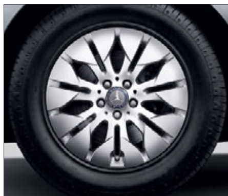
Jante alliage à 7 doubles branches avec pneus 235/65 R 17 (en option sur ML 250 BlueTEC 4MATIC et ML 350 BlueTEC 4MATIC, code R24).
