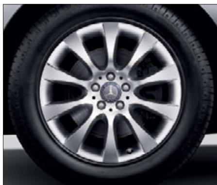
Jante alliage à 10 branches avec pneus 255/55 R 18 (de série sur ML 250 BlueTEC 4MATIC, ML 350 BlueTEC 4MATIC et ML 350 4MATIC BlueEFFICIENCY, code R41).
