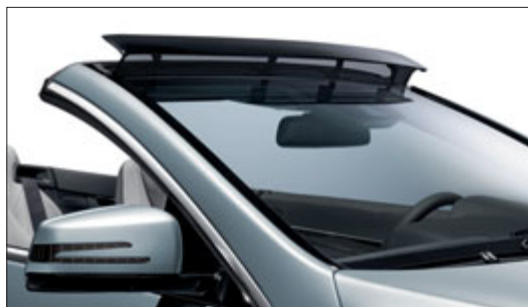
AIRCAP comprend un déflecteur électrique implanté sur le cadre de toit avant.
