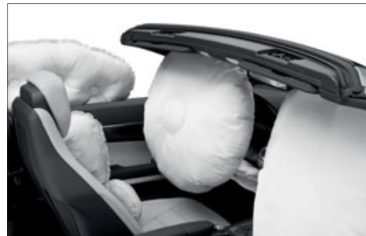
Parfaitement adaptés au corps humain, les airbags offrent une protection intégrale efficace.
