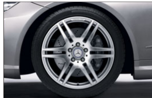
Jante alliage AMG à 6 doubles branches, finition brillante, avec pneus 235/40 R 18 à l'avant et 255/35 R 18 à l'arrière (composant du Pack Sport AMG, code 786).
