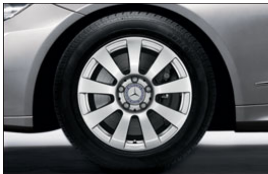
Jante alliage à 9 branches à faible coefficient de frottement avec pneus 205/55 R 16 (uniquement Classe E Coupé 4 cylindres, code R12).
