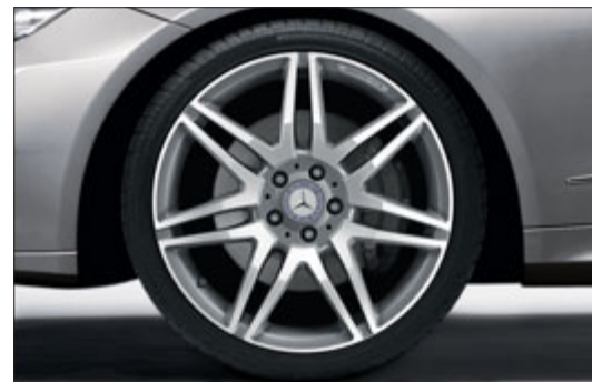
Jante alliage AMG à 7 doubles branches, finition argent Sterling brillant, avec pneus 235/35 R 19 à l'avant et 255/30 R 19 à l'arrière (option, code 770).
