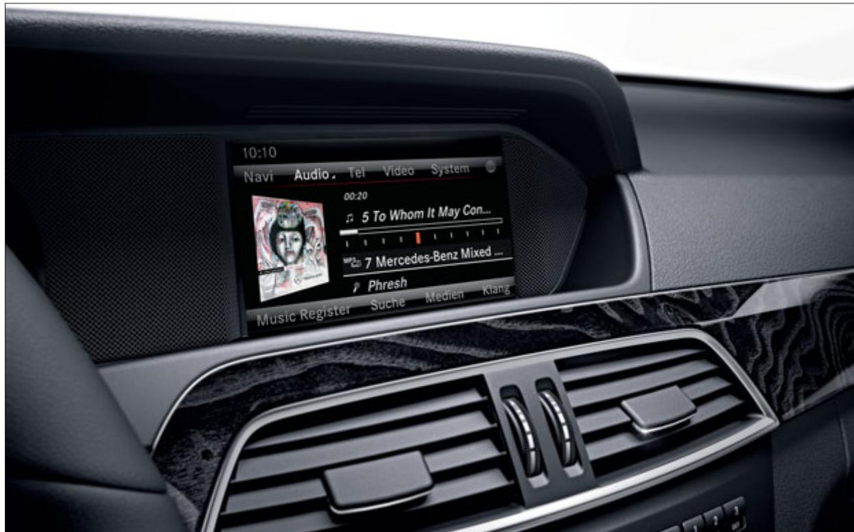
COMAND Online reúne en una sola unidad las funciones de telefonía, audio, navegación e Internet. Utilizando el mando fónico LINGUATRONIC pueden realizarse todos los ajustes importantes por medio de comandos hablados.
