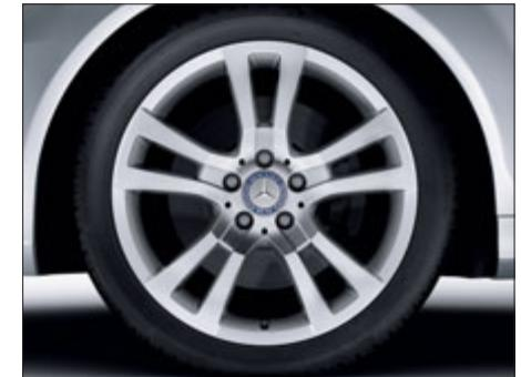
Llanta de aleación de 5 radios dobles con neumáticos 225/40 R 18 delante y 255/35 R 18 detrás (opcional, código R70).
