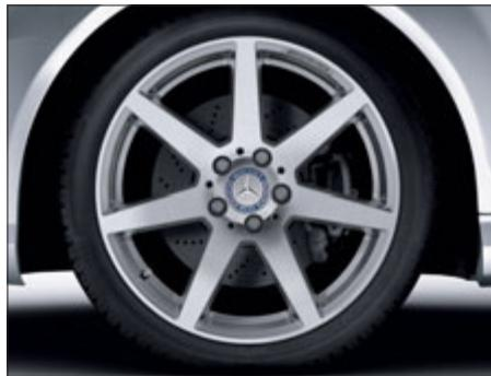
Llanta de aleación AMG de 7 radios con neumáticos 225/40 R 18 delante y 255/35 R 18 detrás, pulida a alto brillo (opcional, no para el C 63 AMG, código 782).
