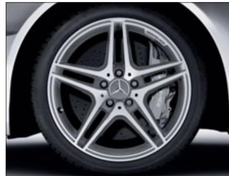
Llanta de aleación AMG de 5 radios dobles con neumáticos 235/40 R 18 delante y 255/35 R 18 detrás, color gris titanio y pulida a alto brillo (de serie para el C 63 AMG, código 795).
