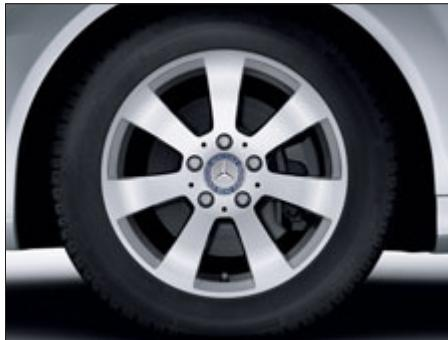
Llanta de aleación de 7 radios con neumáticos 205/55 R 16 (código R75)<sup>1</sup>.
