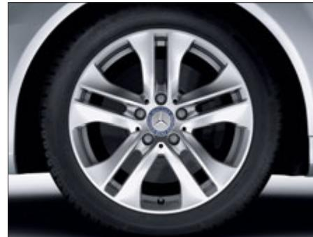
Llanta de aleación de 5 radios dobles con neumáticos 225/45 R 17 (de serie con la línea de acabado AVANTGARDE, código 44R).
