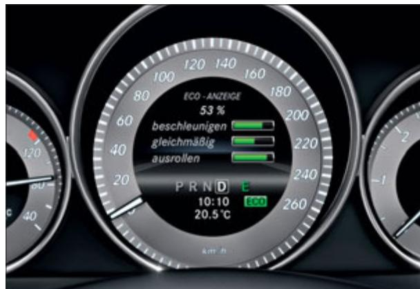
El indicador ECO informa de la eficiencia del propio estilo de conducción.
