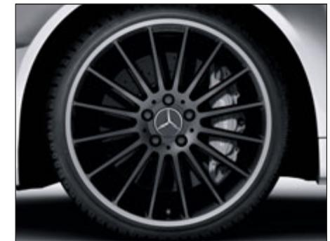
Llanta de aleación AMG multirradio con neumáticos 235/35 R 19 delante y 255/30 R 19 detrás, color negro mate con pestaña pulida a alto brillo (opcional para el C 63 AMG, código 797).
