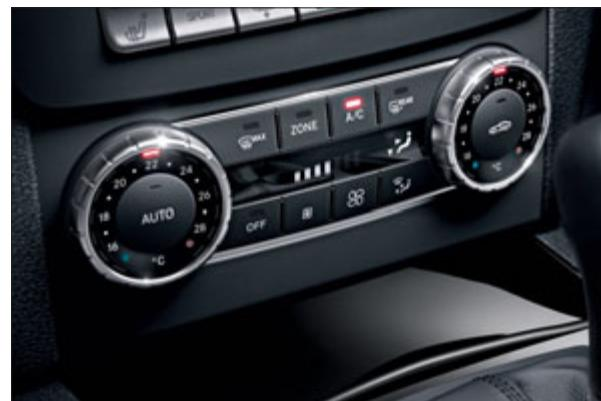
THERMATIC utiliza la información recibida de sensores que comunican la temperatura interior y exterior y la humedad del aire.
