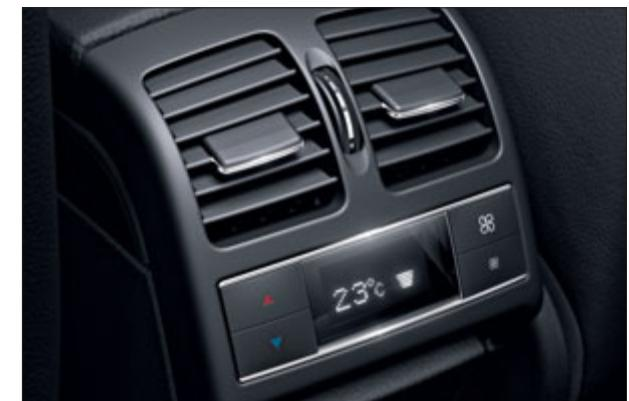
Con la unidad de mandos separada en la parte trasera es posible ajustar con precisión la temperatura y el caudal de aire deseados.
