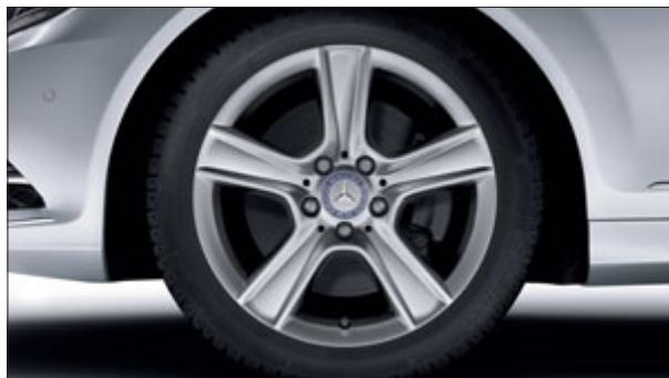
Llanta de aleación Proserpina de 5 radios color plata sterling, neumáticos 225/45 R 17 delante y 245/40 R 17 detrás. Otras llantas previa consulta.
