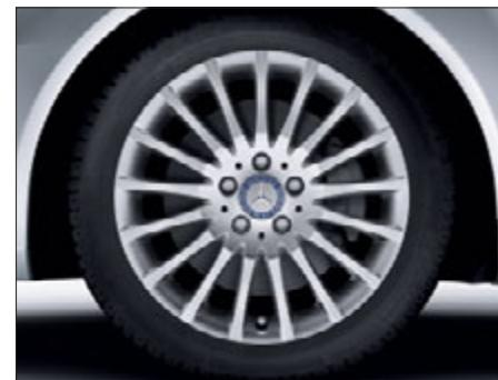
Llanta de aleación multirradio con neumáticos 225/45 R 17 delante y 245/40 R 17 detrás (opcional, código 56R).
