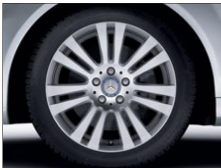
Llanta de aleación de 7 radios dobles con neumáticos 205/55 R 16 (código R27)<sup>2</sup> o 225/45 R 17 (código 26R)<sup>3</sup>.
