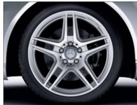
Llanta de aleación AMG de 5 radios dobles con neumáticos 225/40 R 18 delante y 255/35 R 18 detrás, pulida a alto brillo (opcional, no para el C 63 AMG, código 786).
