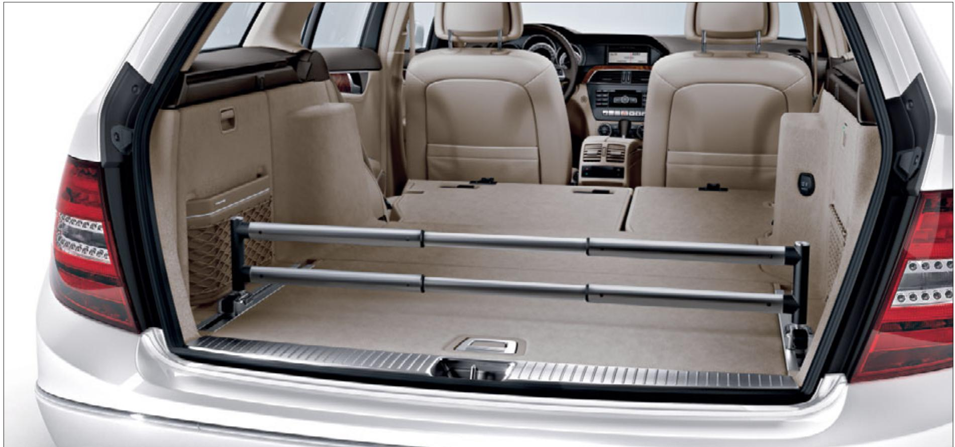
Los rieles del kit de sujeción EASY-PACK pueden ayudar a sujetar el equipaje.
