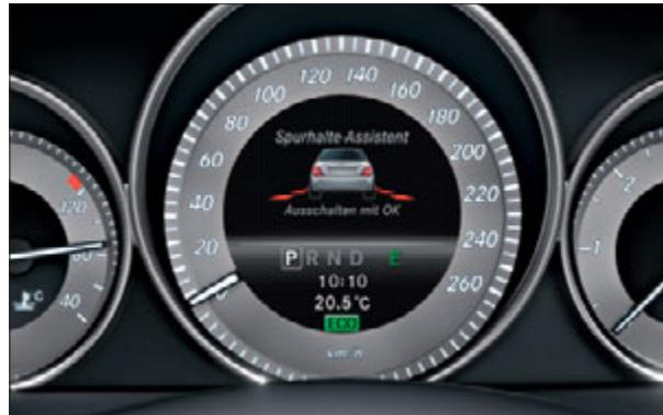
El detector activo de cambio de carril puede advertir al conductor mediante vibraciones en el volante si está a punto de salirse de su carril.
