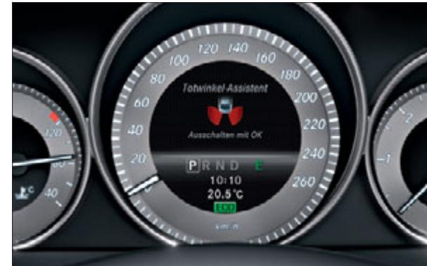
El control activo de ángulo muerto supervisa el área difícilmente visible por el conductor a la izquierda y a la derecha del vehículo.
