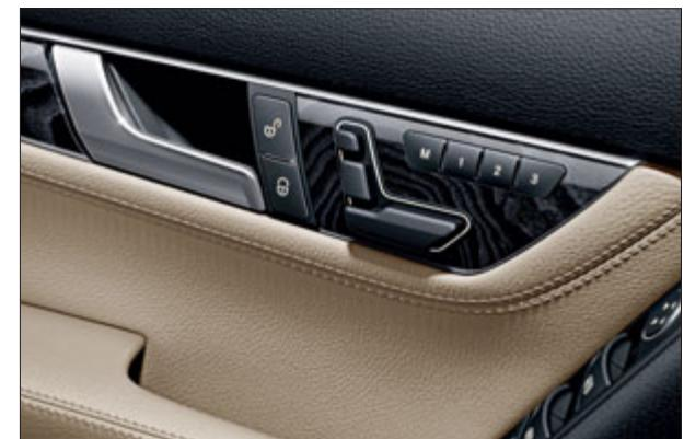
El kit de memorias conserva tres ajustes diferentes para el asiento del conductor, los retrovisores exteriores y la columna de la dirección.
