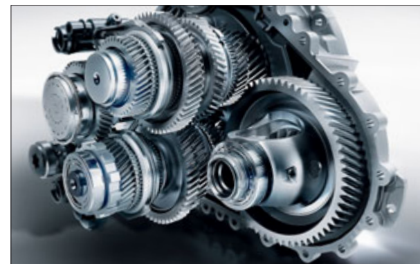
La boîte à double embrayage 7G-DCT favorise des changements de rapports confortables, presque sans interruption de la force motrice.
