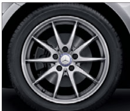
Jante alliage 17" à 10 branches avec pneus 225/45 R 17 (option sur A 250 Inspiration et Sensation, code R43).
