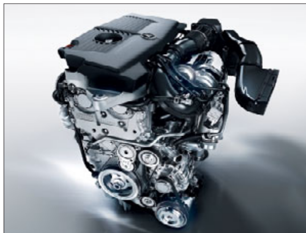
Le moteur essence 4 cylindres de la A 180 BlueEFFICIENCY fait appel à des injecteurs piézoélectriques et à un turbocompresseur.
