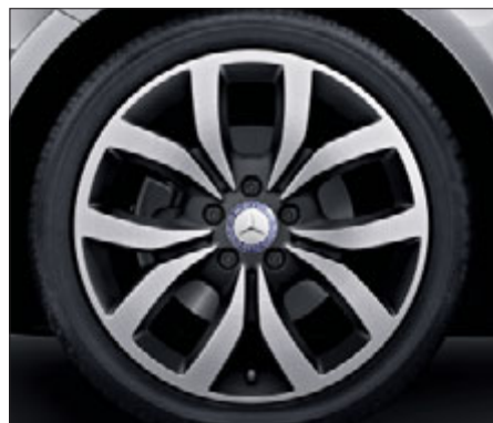
Jante alliage 18" à 5 doubles branches noir mat et finition brillante, avec pneus 225/40 R 18 (uniquement en liaison avec le Pack Sport Black, code R10).
