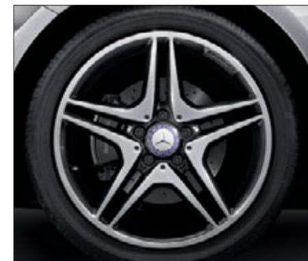
Jante alliage 18" AMG à 5 doubles branches peinte en noir, finition brillante, avec pneus 225/40 R 18 (série sur ligne Fascination, code 781).
