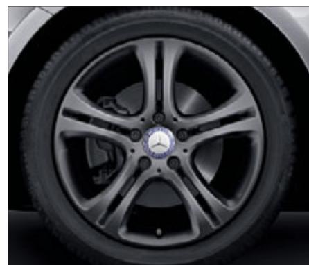
Jante alliage 17" à 5 doubles branches peinte en gris trémolite avec pneus 225/45 R 17 (option sur Intuition, Inspiration et Sensation, code 44R).
