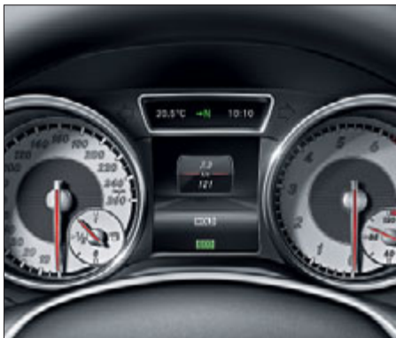
Sdružený přístroj v designu dvou tubusů s barevným multifunkčním displejem TFT.
