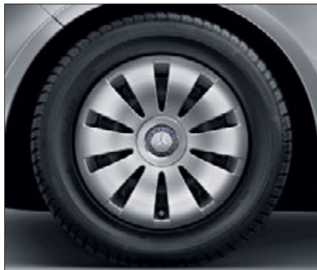
Ocelová kola s ozdobným krytem v designu s 10 otvory a s pneumatikami 195/65 R 15 (standardní výbava pro model CLA 180 BlueEFFICIENCY Edition, kód R00).
