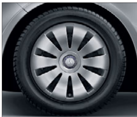
Ocelová kola s ozdobným krytem v designu s 10 otvory a s pneumatikami 205/55 R 16 (příplatková výbava pro model CLA 180 a CLA 200, kód 643).
