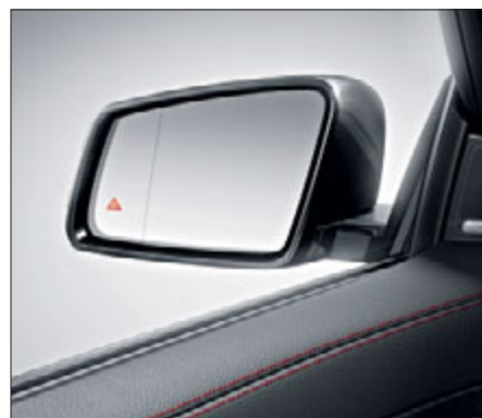
Sada asistentů jízdy v pružích s asistentem jízdy v pružích a asistentem hlídání mrtvého úhlu (obojí k dodání i samostatně) 1 .
