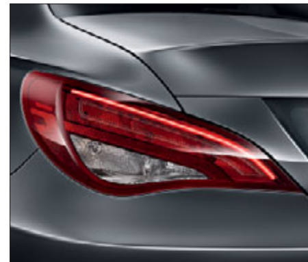
Zadní světla včetně koncového světla v provedení LED.
