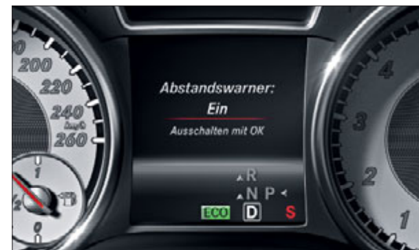
COLLISION PREVENTION ASSIST (asistent prevence před kolizí) dokáže rozpoznat příliš malou vzdálenost a varuje řidiče opticky a akusticky.
