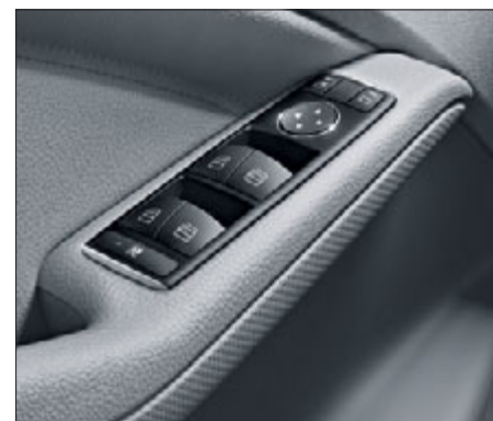
Elektrické ovládání oken.
