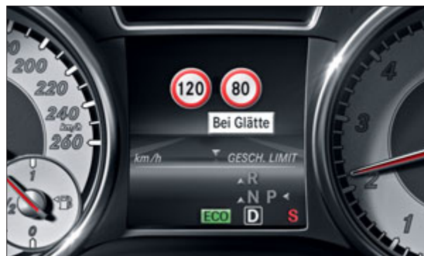
Údaje asistenta rychlostního omezení jsou zobrazeny jak ve sdruženém přístroji, tak na centrálním displeji systému COMAND Online.
