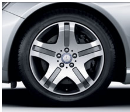
Jantes alliage à 5 branches design V12, pneus 255/45 R 18 (AV) et 275/45 R 18 (AR) (de série sur CL 600).
