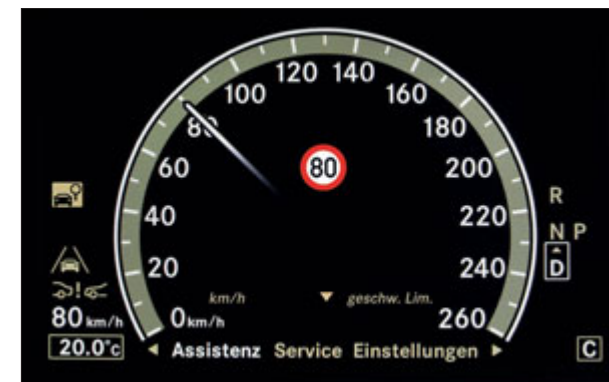
Affichage du rappel de limitation de vitesse sur le combiné d'instruments.
