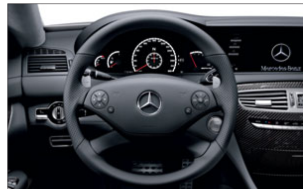
Volant sport AMG avec palettes de commande de boîte en aluminium argenté.
