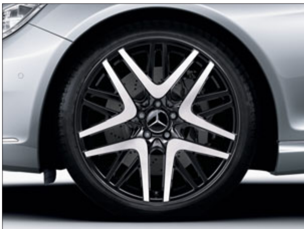
Jante alliage incenio 1 « Behes » à 5 branches en Y, pneus 255/35 R 20 à l'avant et 275/35 R 20 en option à l'arrière.
