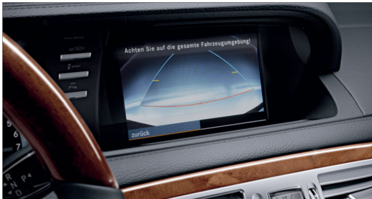
Visibilité panoramique lors des manœuvres de stationnement et des marches arrière grâce à la caméra de recul (option).
