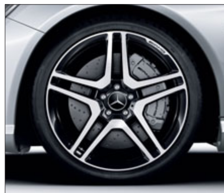
Jantes alliage AMG à doubles branches, pneus 255/35 R 20 (AV) et 275/35 R 20 (AR), finition noire polie (option pour CL 63 AMG et CL 65 AMG, code 753).
