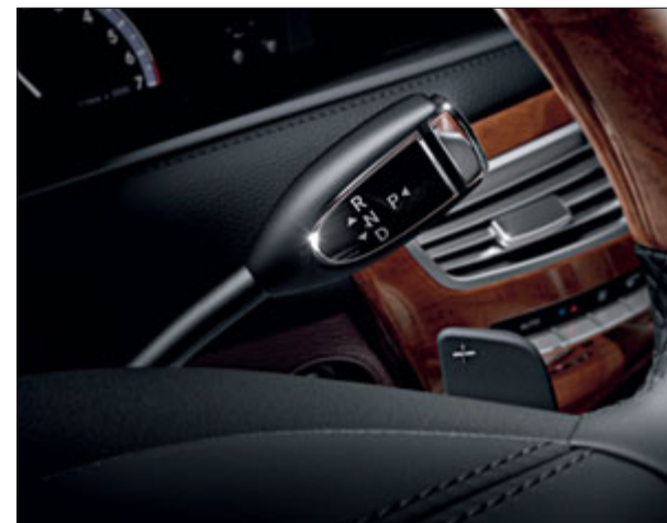
Le passage des rapports se fait par simple pression sur une touche du levier sélecteur DIRECT SELECT au volant.
