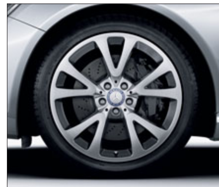
Jantes alliage à 5 branches en Y, pneus 255/40 R 19 (AV) et 275/40 R 19 (AR), ou 255/40 R 19 aux 4 roues avec 4MATIC, finition argent titane brillant (option, code R55 ou R17).
