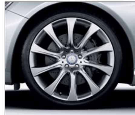
Jantes alliage « Alaraph » à 10 branches, pneus 255/35 R 20 (AV) et 275/35 R 20 (AR), ou 255/35 R 20 aux 4 roues avec 4MATIC, finition argent Sterling (Accessoires départ usine).
