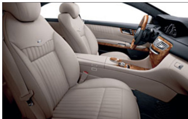
Sièges multicontours actifs avant avec fonction massage et fonction dynamique.
