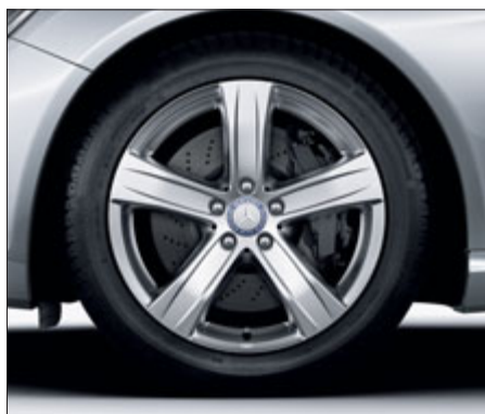
Jantes alliage à 5 branches, pneus 255/45 R 18 aux 4 roues (de série sur CL 500 BlueEFFICIENCY).
