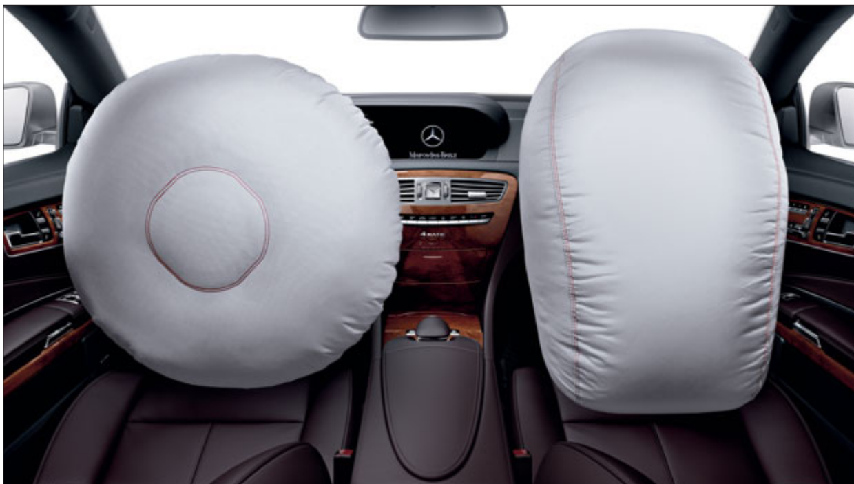
Au total, huit airbags peuvent protéger les occupants du véhicule en cas d'accident.
