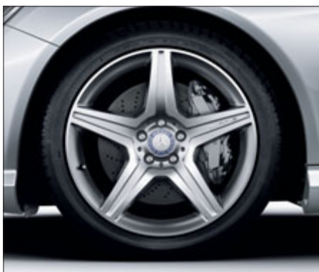
Llanta de aleación AMG de 5 radios; neumáticos 255/40 R 19 delante y 275/40 R 19 detrás; con 4MATIC, 255/40 R 19 en ambos ejes, pulida a alto brillo (paquete deportivo AMG).
