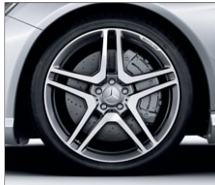
Llanta forjada AMG de radios dobles con neumáticos 255/35 R 20 delante y 275/35 R 20 detrás, gris titanio y pulida (de serie para CL 65 AMG, opcional para CL 63 AMG).
