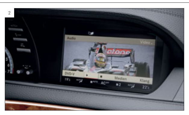
SPLITVIEW visualiza simultáneamente contenidos diferentes para el conductor (1) y el acompañante (2) en una misma pantalla.
