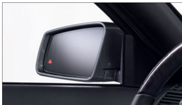
El control activo de ángulo muerto incrementa la seguridad en los cambios de carril.
