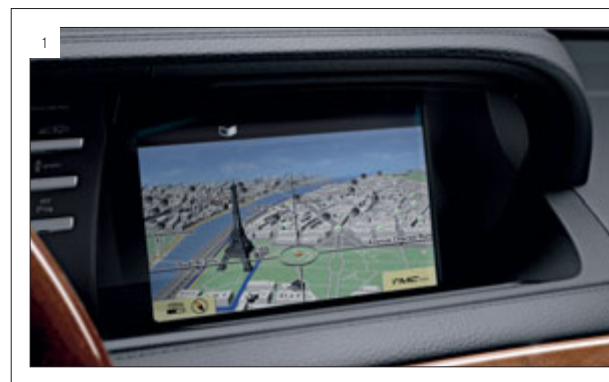
SPLITVIEW visualiza simultáneamente contenidos diferentes para el conductor (1) y el acompañante (2) en una misma pantalla.
