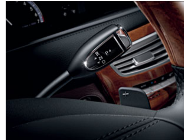
Manejo del cambio pulsando un botón con la palanca selectora DIRECT SELECT en el volante.
