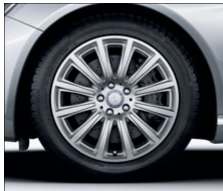
Llanta de aleación de 12 radios con neumáticos 255/45 R 18 delante y 275/45 R 18 detrás, con 4MATIC, 255/45 R 18 en ambos ejes, color plata titanio y pulida a alto brillo (opcional).
