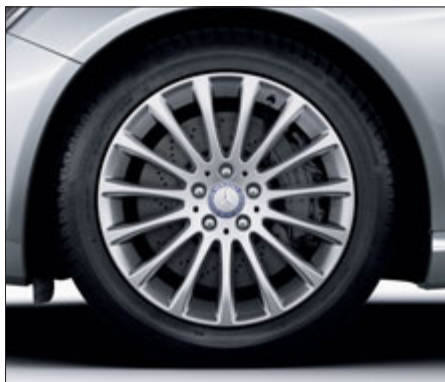
Llanta de aleación de 15 radios con neumáticos 255/45 R 18 delante y 275/45 R 18 detrás, CL 500 4MATIC BE 255/45 R 18 en ambos ejes (opcional, de serie para CL 500 4MATIC BE).
