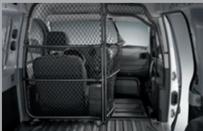
Lastschutzgitter. Die optionale klappbare Gittertrennwand sorgt im Kastenwagen für mehr Ladelänge und schützt die Insassen.
