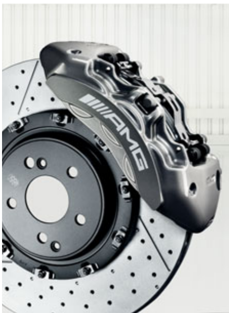
Equipamiento de serie en el SLS AMG. Equipo de frenos de alto rendimiento AMG con discos de material compuesto.
