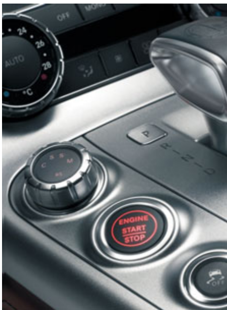
AMG DRIVE UNIT con palanca selectora E-SELECT y función de arranque KEYLESS-GO.
