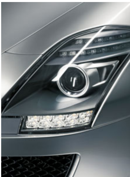
Faros bixenón con luces diurnas de diodos luminosos integradas.
