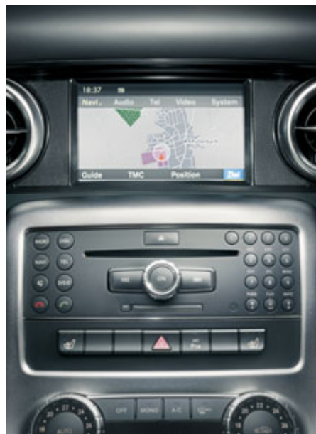
Equipamiento de serie. Pantalla en color TFT de 17,8 cm de diagonal para reproducir mapas de carreteras en alta definición.
