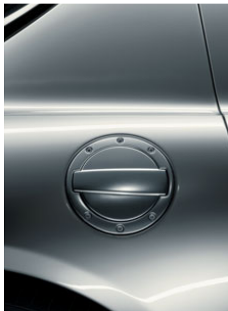
Tapa del depósito de metal macizo, atornillada.
