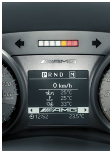
Cuadro de instrumentos AMG con recomendación para cambiar a una marcha superior (7 LED).
