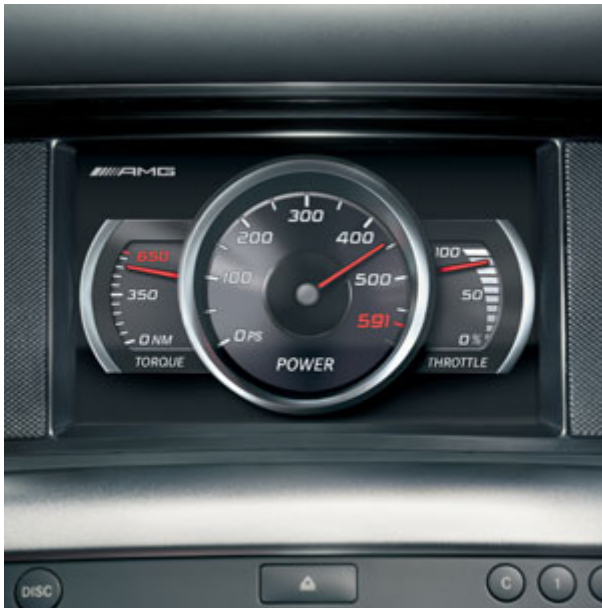
Equipo opcional. AMG Performance Media, visualización del par motor, la potencia y la posición del acelerador.
