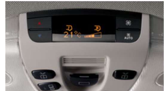
Zusatzwärmetauscher für den Fond mit separater Bedieneinheit.
