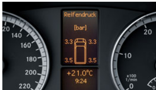
Das automatische Reifendruck-Kontrollsystem.
