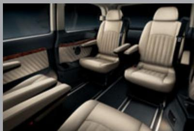
Los asientos traseros pueden desplazarse fácilmente sobre guías con una trama de 25 mm, permitiendo las más variadas configuraciones. Todos los asientos brindan una extraordinaria sujeción lateral.
