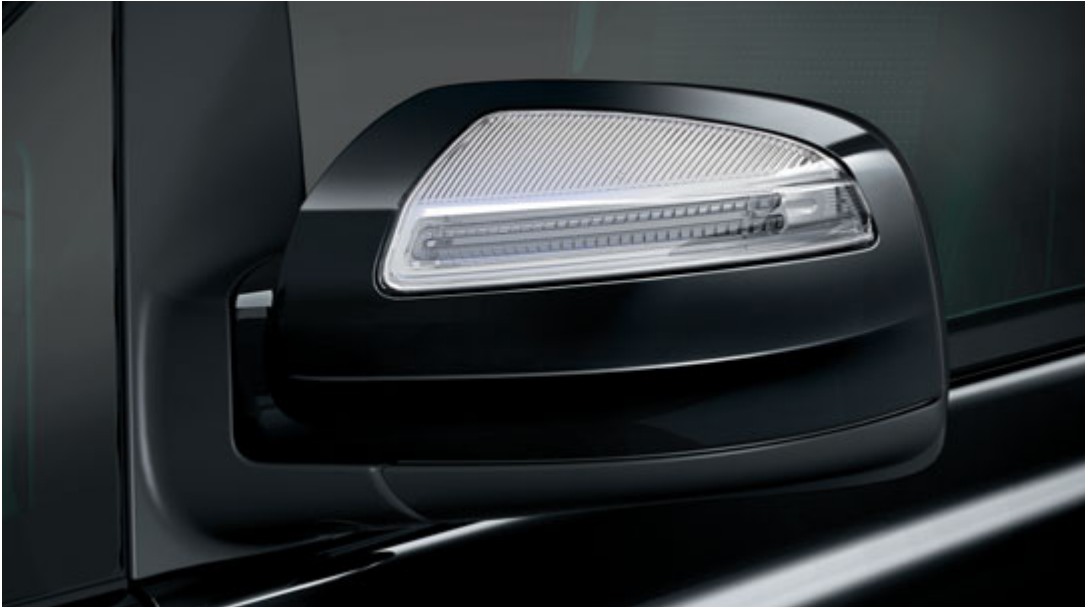
Außenspiegel mit vergrößertem Sichtfeld und integrierter Blinkleuchte, elektrisch einstellbar.
