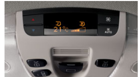
Zusatzwärmetauscher für den Fond mit separater Bedieneinheit.
