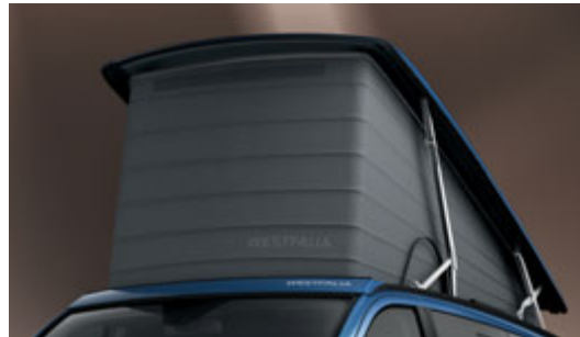
Elektrohydraulisches Aufstelldach EASY UP.
