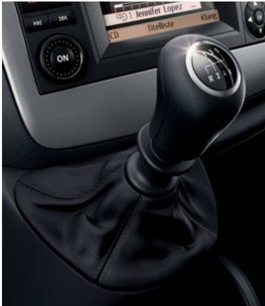
Das 6-Gang-Schaltgetriebe ECO Gear für CDI-Motoren 2.0 und 2.2.
