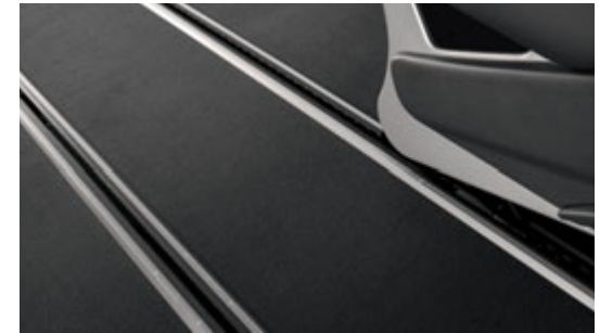
Das Sitzschienensystem für variable Innenraumkonfiguration.
