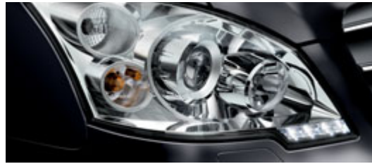
Bi-Xenon-Scheinwerfer mit Abbiege-, Nebel- und LED-Tagfahrlicht.
