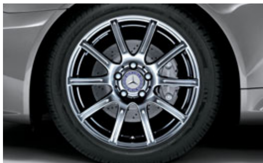
Jante alliage 43 cm (17") à 10 branches en finition brillante « chrome shadow » avec pneus en 225/45 R 17 à l'avant et 245/40 R 17 à l'arrière.
