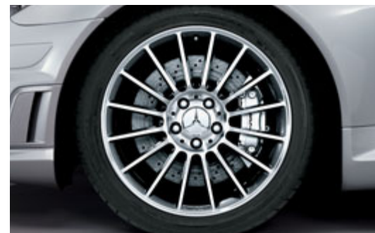
Jante alliage AMG 46 cm (18") multibranches, peinte en gris titane, finition brillante, avec pneus en 225/40 R 18 à l'avant et 245/35 R 18 à l'arrière (de série sur le SLK 55 AMG).
