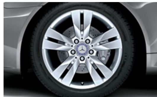
Jante alliage 43 cm (17") à 5 doubles branches avec pneus en 225 / 45 R 17 à l'avant et 245 / 40 R 17 à l'arrière (uniquement avec le train de roulement sport).
