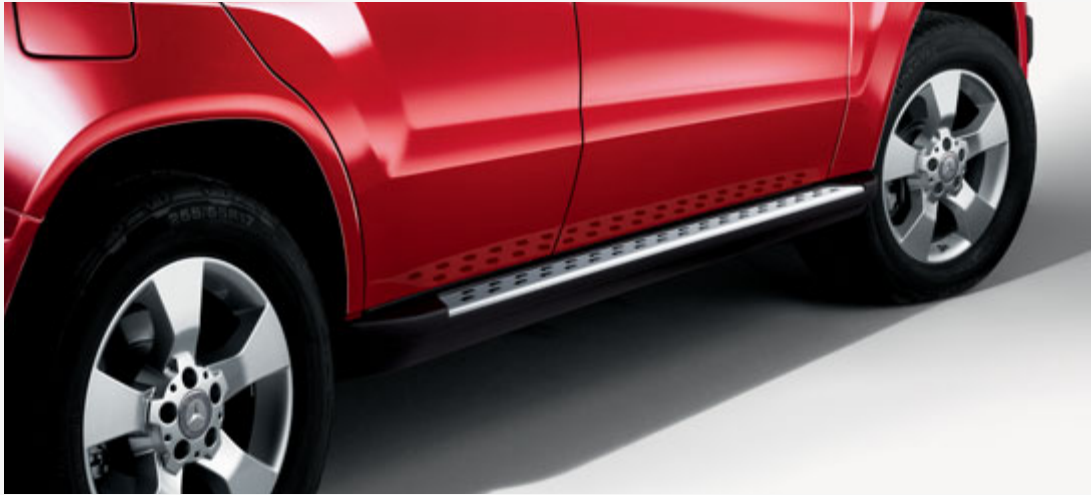
Marchepied avec inserts en acier inoxydable et picots en caoutchouc.
