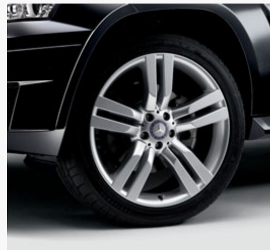
Imposantes jantes alliage design 5 doubles branches avec monte mixte 235/45 R 20 à l'avant et 255/40 R 20 à l'arrière (option).
