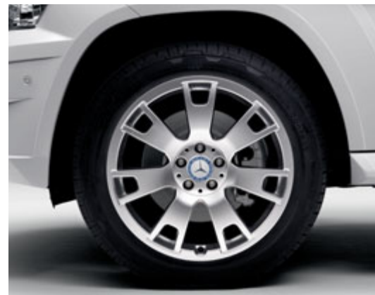
Jantes alliage à 7 branches, monte mixte 235/50 R 19 à l'avant et 255/45 R 19 à l'arrière (option; code 38 R).
