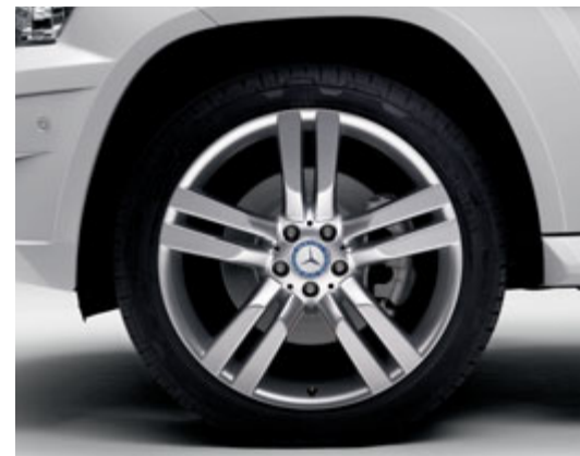
Jantes alliage à 5 doubles branches, monte mixte 235 / 45 R 20 à l'avant et 255 / 40 R 20 à l'arrière (option avec Pack Sport Ext., R 98).
