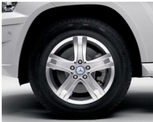
Jantes alliage à 5 branches, monte mixte 235/60 R 17 à l'avant et 255/55 R 17 à l'arrière (option; code 37 R).
