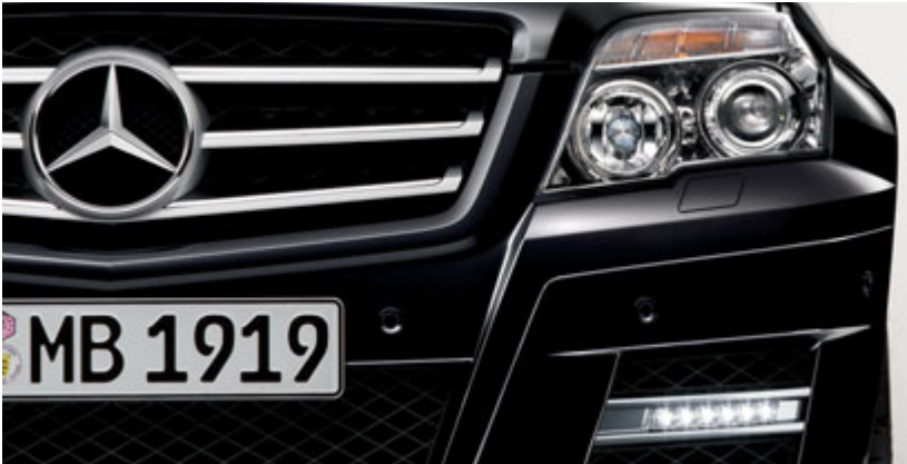
Intelligent Light System avec projecteurs bi-xénon et feux de jour à LED intégrés.
