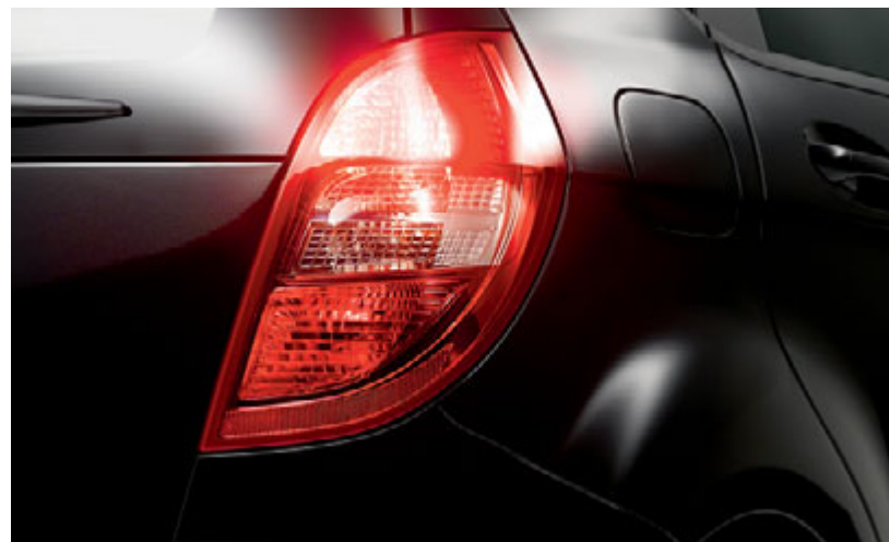
Les feux de stop adaptatifs clignotants signalent clairement un freinage d'urgence.
