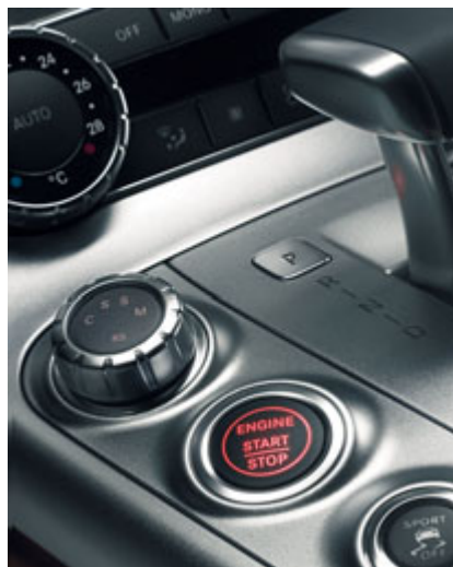
DRIVE UNIT AMG avec levier sélecteur E-SELECT et fonction de démarrage KEYLESS-GO.
